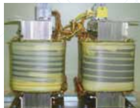
Scott-Trafo 2x22,5kVA 3x400V/2x950V 70Hz
